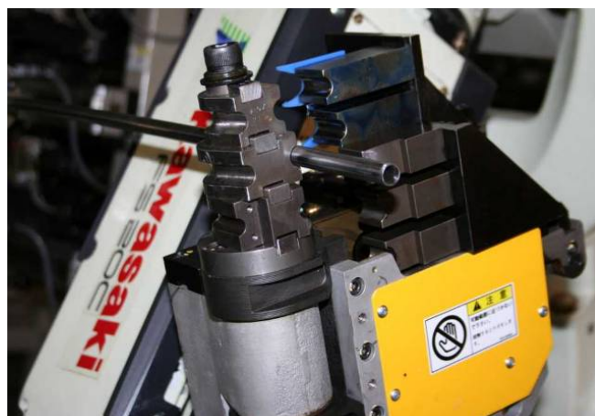
写真は、金型3種類の搭載例
