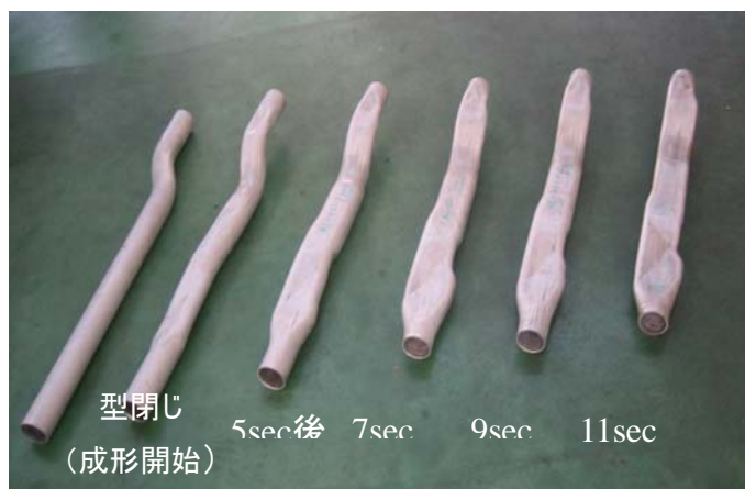
ハンマリング式ハイドロ加工成形プロセス
